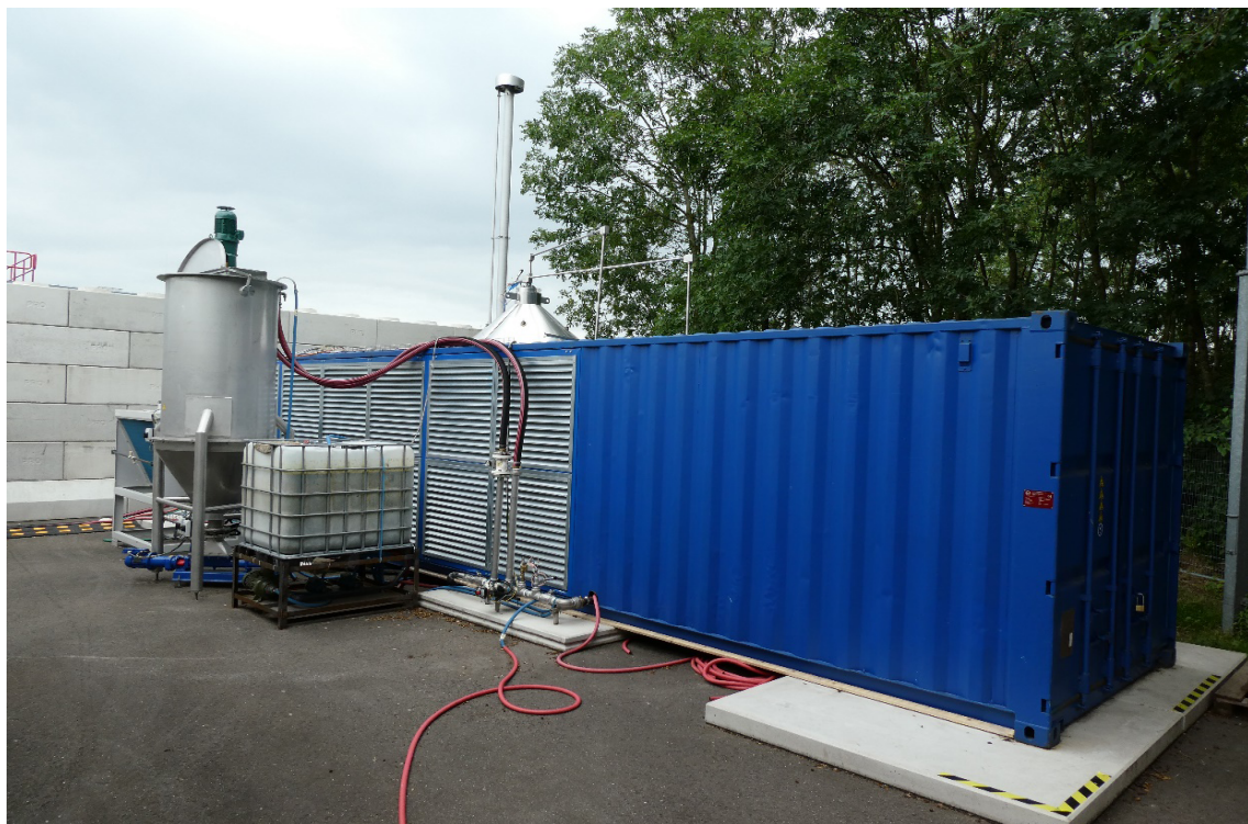
FIGUUR 1 DE PILOTINSTALLATIE VOOR SUPERKRITISCHE VERGASSING VAN HET SUPERSLUDGE CONSORTIUM IN DINTHER
