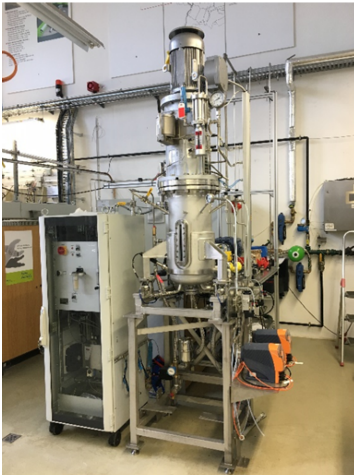
FIGUUR 8 GEAUTOMATISEERDE PILOT PLANT VOOR BIOLOGISCHE METHANISERING
